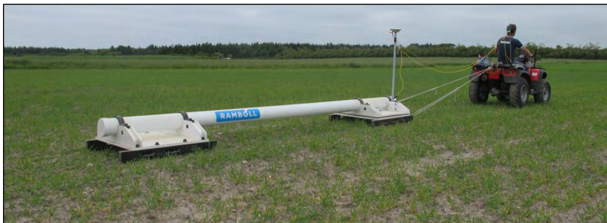
Figur 14 Instrument setup, placeret på en slæde som trækkes bag en ATV.
